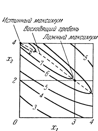
Рис. 3.11. Линии уровня поверхности, изображенной на рис. 3.10.
